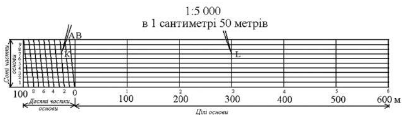
Рис. 2.2. Нормальний поперечний масштаб.
