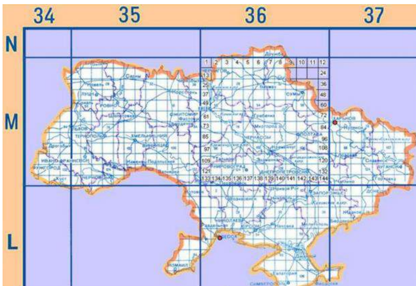
Рис. 2.15. Визначення розміщення Києва в межах аркушу з номенклатурою М-36.
