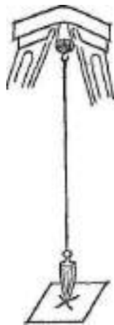
Рис. 1.84. Центрування за допомогою виска.
