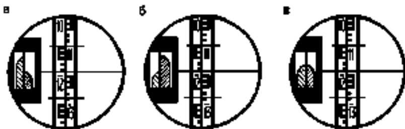
Рис. 1.108. Поле зору зорової труби нівеліра Н-3 із положенням бульбашки циліндричного рівня поза нуль-пунктом (а, б) та у нуль-пункті (в)
