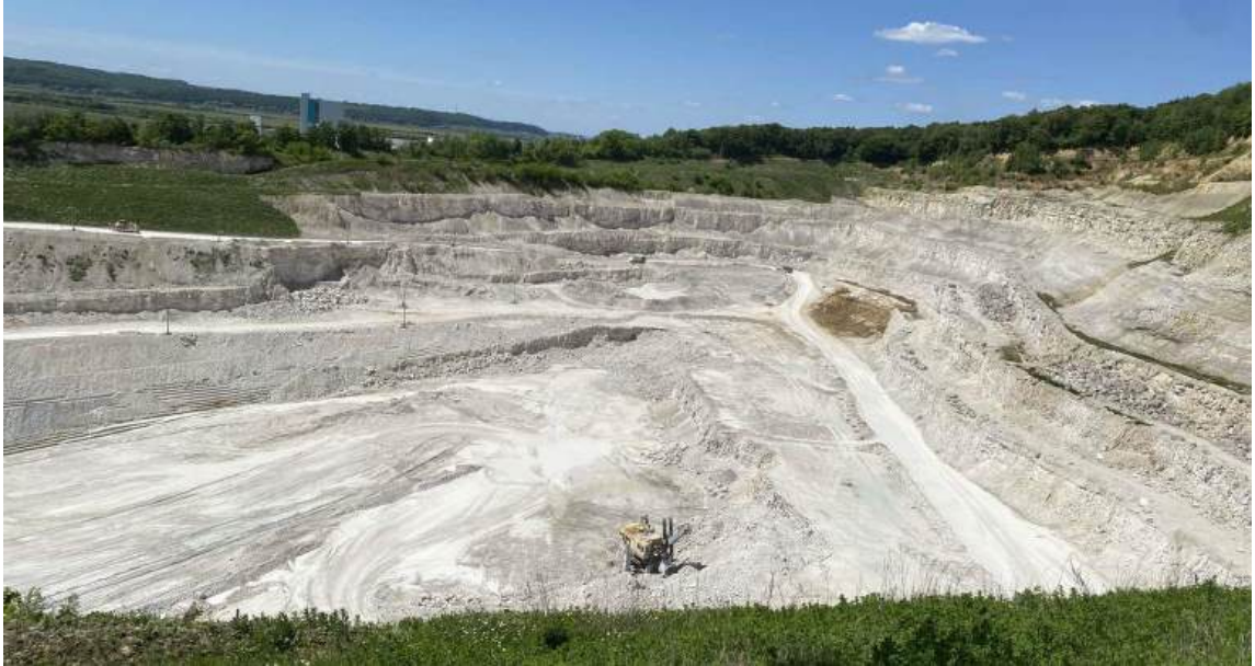
Рис. 4.12. Північна частина кар'єру (днище і різнорівневі робочі уступи, які з'єднані кар'єрними дорогами)
