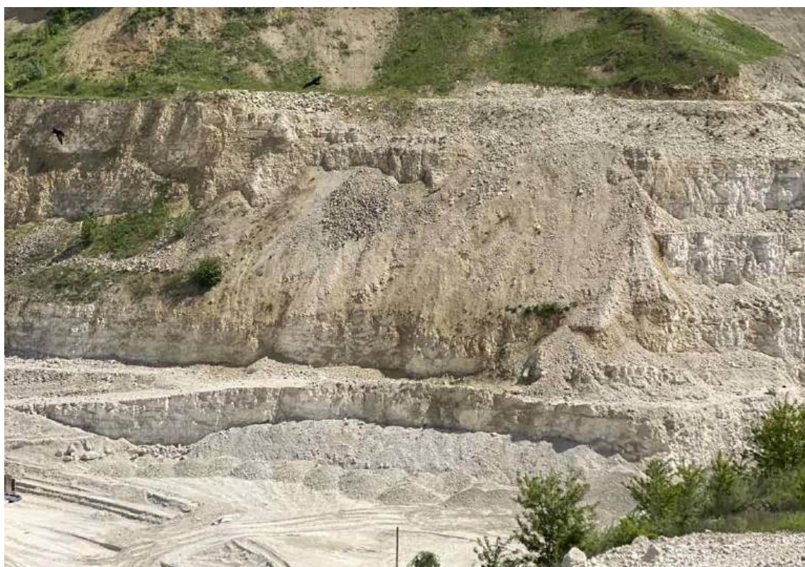
Рис. 4.16. Осипні процеси, які охоплюють один або декілька уступів
