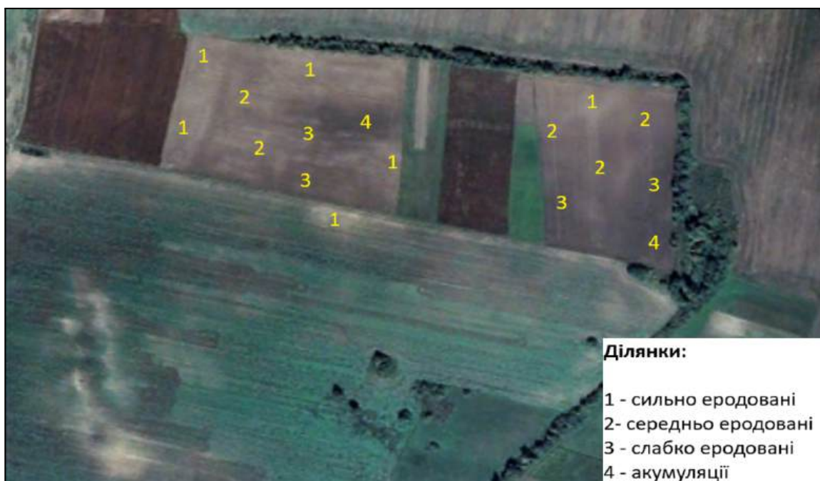
Рис. 9. Площинна ерозія на міжuloговинних поверхнях горбисто-западинного типу, на яких проводилися польові дослідження (околиці с. Моголяни Рівненського р-ну, ресурс Google Earth)
