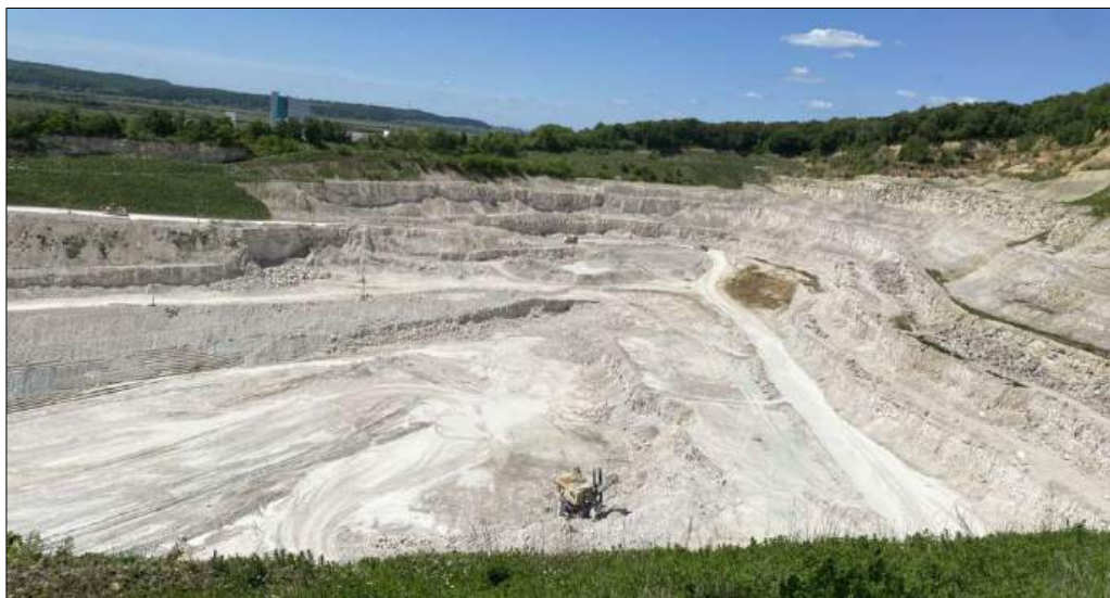
Рис. 1. Північна частина кар’єру (днище і різнорівневі робочі уступи, які з’єднані кар’єрними дорогами)
