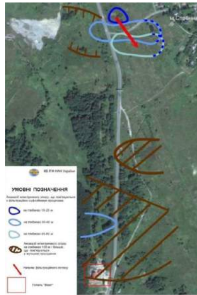
Рис. 12. Схема розміщення аномальних зон за результатами електромагнітних зондувань на ділянці вздовж автодороги Східниця – Пісочне [31, с. 87]
