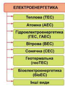
Мал. 88. Склад електроенергетики
