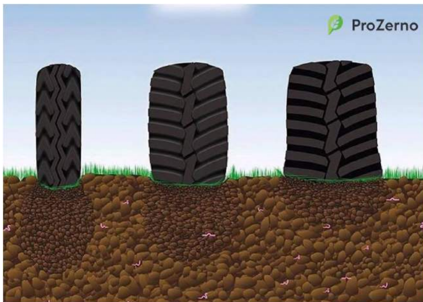
Рис. 5. Вплив розміру шин на ущільнення ґрунту при перевезенні одного і того ж вантажу
