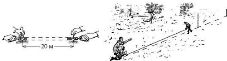
Процес вимірювання довжин ліній на місцевості безпосереднім способом полягає в послідовному укладанні мірного приладу у створі певної лінії.
