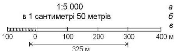
**МАСШТАБ ПОПЕРЕЧНИЙ** – графік для точного вимірювання і відкладення відстаней на карті.
