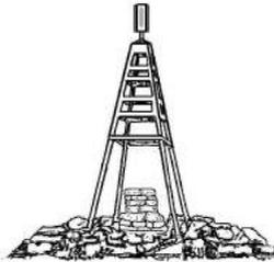
Деколи в Т. вмонтовують трубу, в яку під час вимірювань встановлюють візирний циліндр. Форма Т. – чотиригранна зрізана піраміда заввишки до 1,2 м. Т. закладають на глибину залягання скельної породи.
