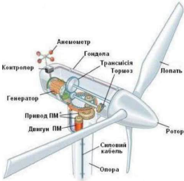
Рис. 3.1. Типовий вигляд та будова ротора турбіни вітрової електростанції [20]
