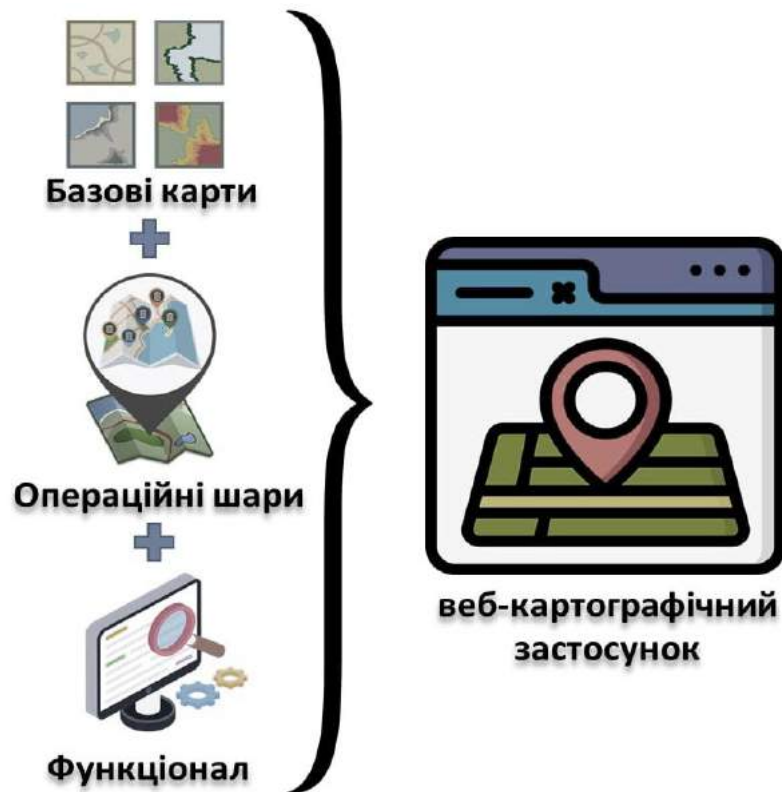
Рисунок 19. Структура веб-картографічного застосунку
