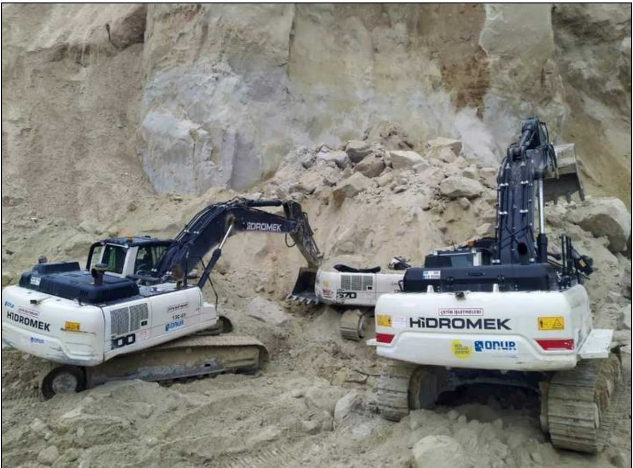
Рис. 5.8. Обвал піщаної породи на кар'єрі [46]
