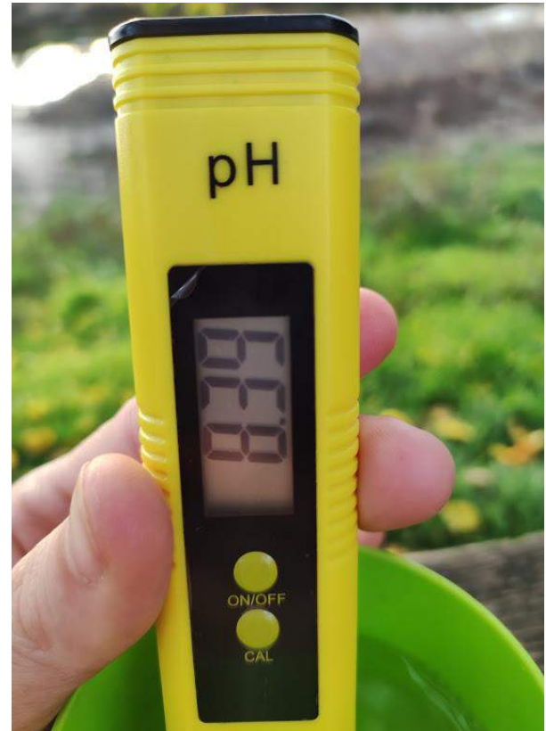
Рис. 2.2 Вимірювання показників рН метром DELFA-PH2 плюс на пості спостереження у с.Новоселівка
