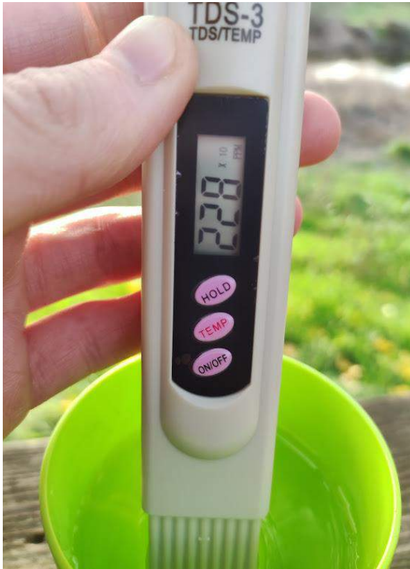
Рис. 1.1 Вимірювання показників мінералізації солеміром TDS-3 на пості спостереження у с.Новоселівка
