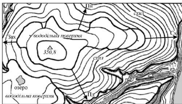
Рис. 3. Встановлення експозиції схилу способом проведення ліній, перпендикулярних до горизонталей, у напрямі від вершини до підніжжя схилу
