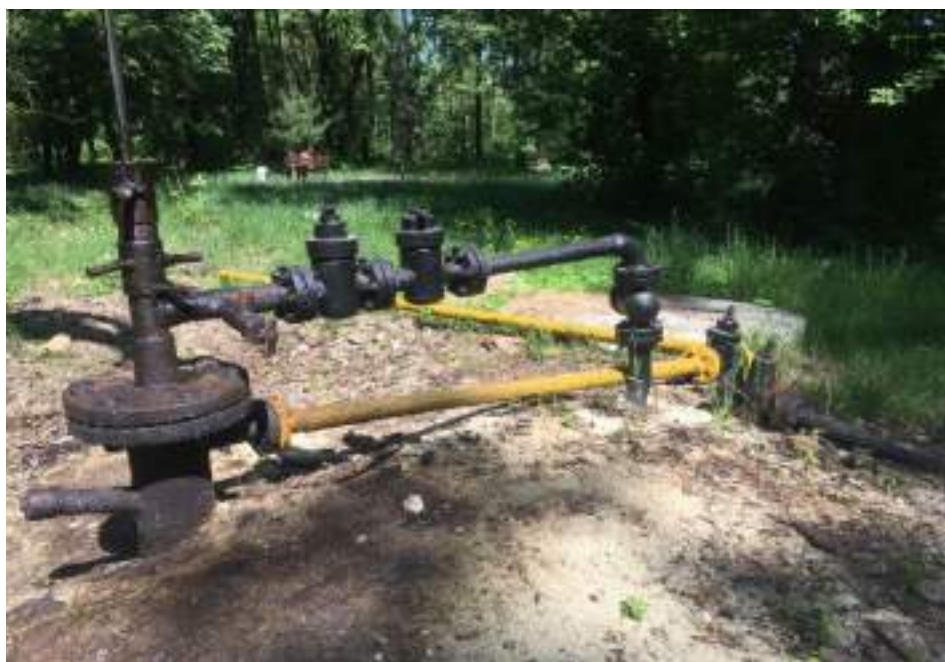
Рис. 2.3. Відведення нафти і газу від свердловини у процесі їх видобутку
