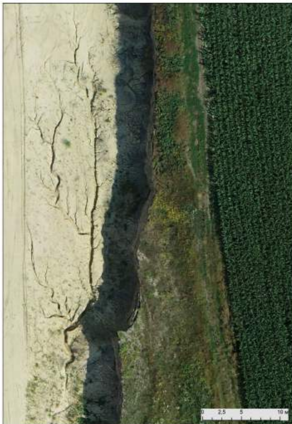
Рис. 1. Лінійні ерозійні форми у південно-східній частині кар'єру в с. Користова (ортофотоплан 07.2021 р.)
