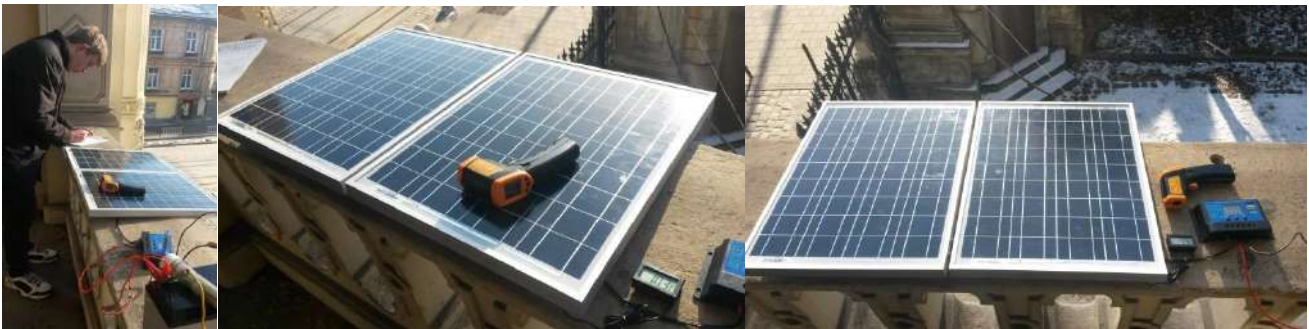
Рис. 2. Дослідження нагрівання сонячних панелей і твердих поверхонь будівель у палаці Сапіги
