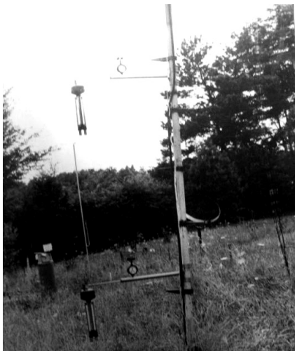
Градiєнтна щогла з психрометрами та анемометрами.
