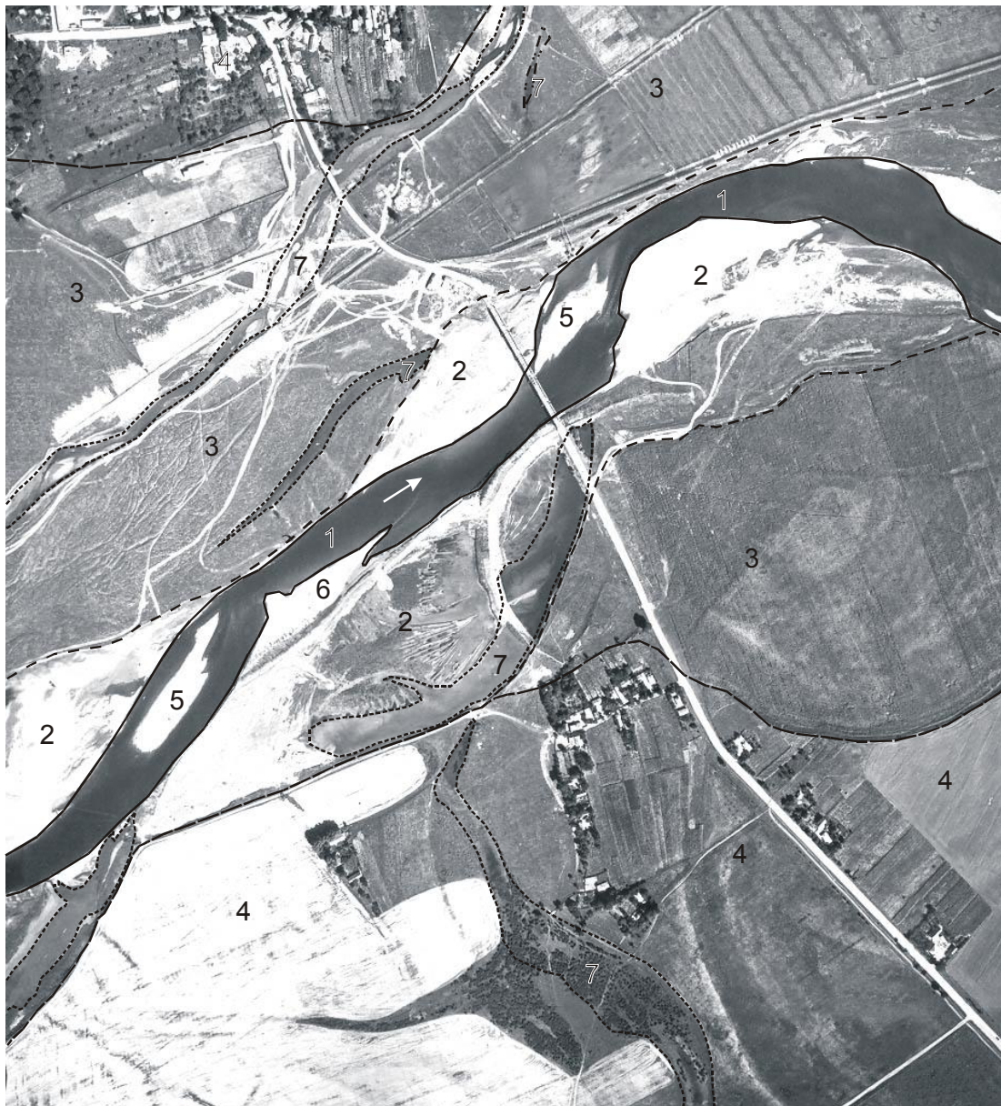
Рис. 11. Результат геоморфологічного дешифрування аерофотознімка. Елементи і форми рельєфу: 1 – русло ріки; 2 – низька заплава; 3 – висока заплава; 4 – перша надзаплавна тераса; 5 – острови у руслі; 6 – побочень; 7 – стариці
